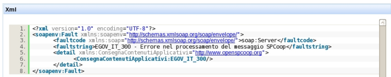
Fig. 3.29: Dettaglio di un errore applicativo (fault)
