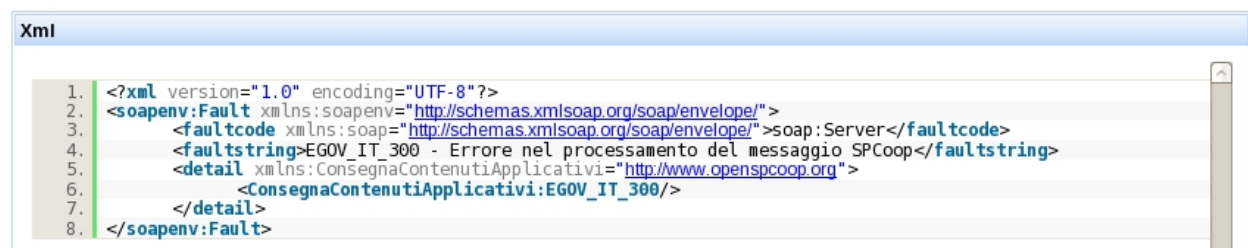
Fig. 3.27: Dettaglio di un errore applicativo (fault)
