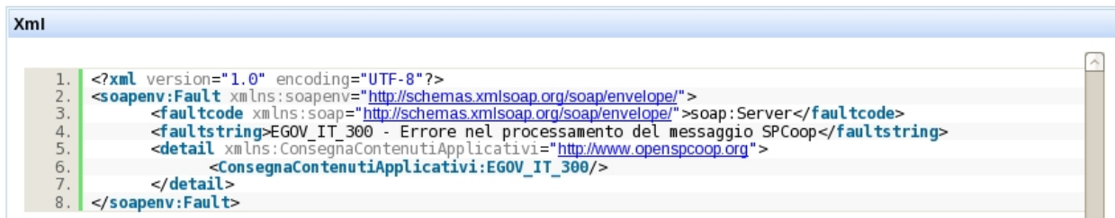
Figure3.33: Dettaglio di un errore applicativo (fault)
