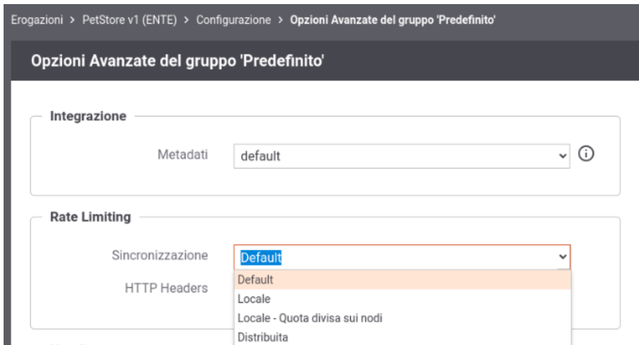
Fig. 2.103: Sincronizzazione del Rate Limiting in un cluster di nodi
